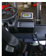
KPZ 39 Váha pro hydraulické vysokozdvížeň zařízení
