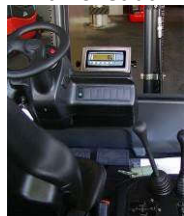
KPZ 39 Váha pro hydraulické vysokozdvížeň zařízení
