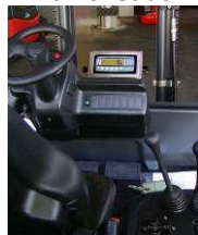
KPZ 39 Váha pro hydraulické vysokozdvizné zařízení
