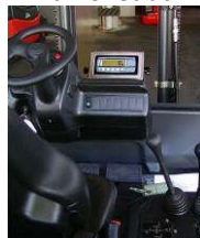
KPZ 39 Váha pro hydraulické vysokozdvížečné zařízení
