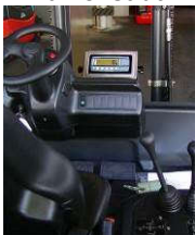
KPZ 39 Váha pro hydraulické vysokozdvizné zařízení
