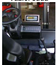
KPZ 39 Váha pro hydraulické vysokozdvizné zařízení
