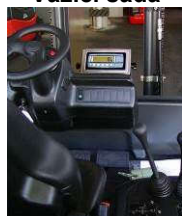
KPZ 39 Váha pro hydraulické vysokozdvizné zařízení
