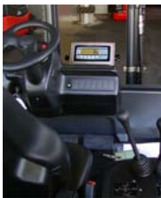
KPZ 39 Váha pro hydraulické vysokozdvíže zařízení
