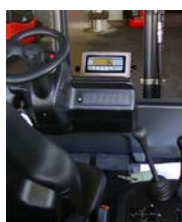
KPZ 39 Váha pro hydraulické vysokozdvíže zařízení
